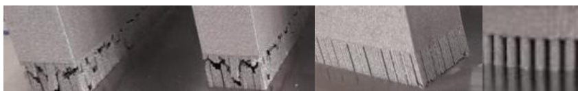
Ilustración 22. Defectos en los soportes de las piezas.
