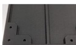
Granallado + tratamiento químico Intensidad: 0
