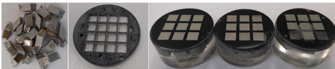
Ilustración 24. Muestras cortadas, placa de separación y probetas embutidas en frío.
