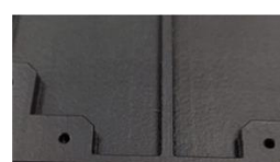
Granallado + tratamiento químico Intensidad: 1
