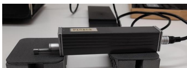
Ilustración 4. Rugosímetro utilizado Mitutoyo modelo SJ301
