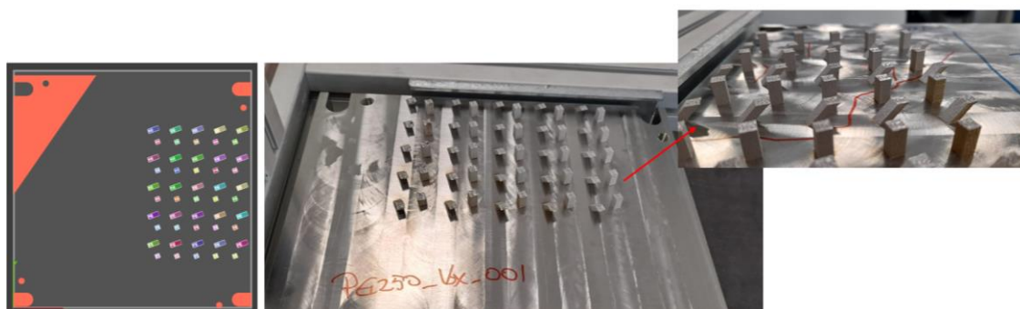
Ilustración 23. Bandeja de fabricación de material VX01 y las piezas fabricadas en la placa
